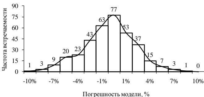
Рисунок 5 – Диаграмма распределения погрешности модели электропотребления в системе водоотведения
