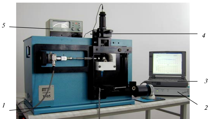
Рис. 4. Внешний вид компьютеризированного триботестера модели Т-05, оснащенного трибодилатометром PCLW-02. (1 — тестер Т-05; 2 — системный блок; 3 — персональный компьютер; 4 — трибодилатометр PCLW-02; 5 — усилитель.
