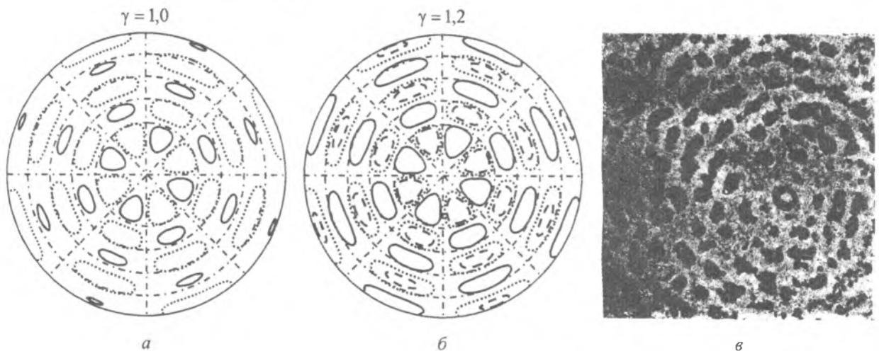
Рис. 3. Влияние степени тепловой неравновесности процесса на конфигурацию кристаллических участков (а, б); экспериментальный пример (в) периодической структуры [1]
