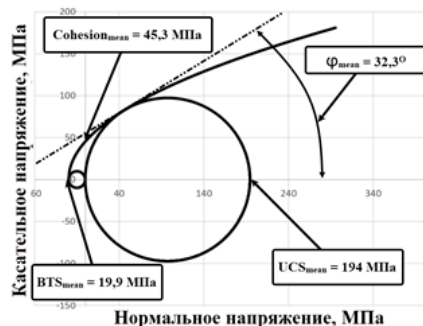
Рисунок 2 – Пример построения паспорта прочности горной породы по авторской методике
