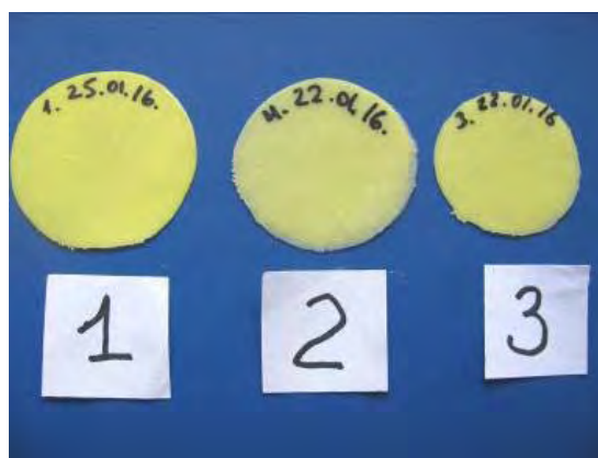
Рисунок 7. – Полимерно-кристаллические оптические композиты на основе матрицы полиэтилена высокого давления ПЭВД и порошка YAG:Ce
