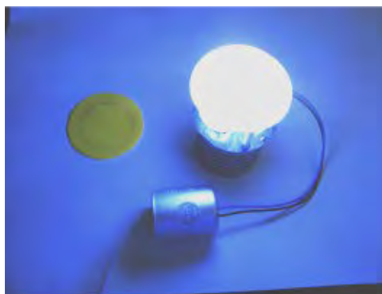
Рисунок 10. – Макет светодиодного светильника с круглым полимерно-кристаллическим светопреобразователем
