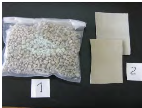
Рисунок 4 – Фотографии гранулированного материала (1) и ленты (2), полученной на основе кукурузного крахмала, сорбитола, белого полипропилена, с использованием компатибилизатора – малеинового ангидрида
