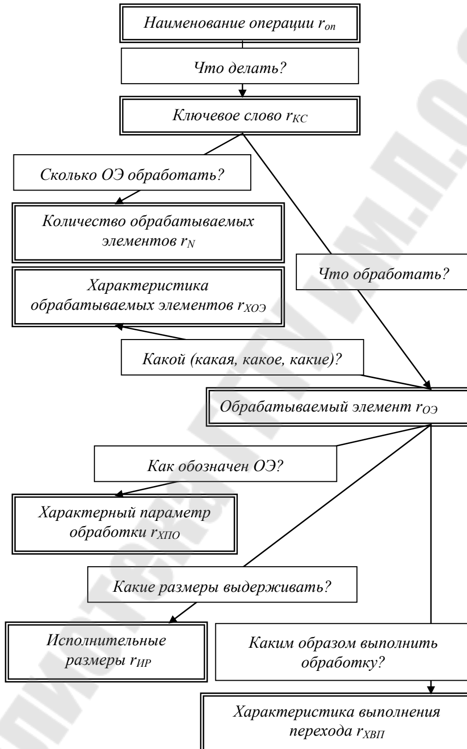
Рис. 4.3. Универсальная схема формирования технологических переходов
