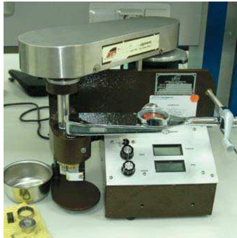
Рис. 6.1. Тестер предельного давления и смазывающей способности OFITE
