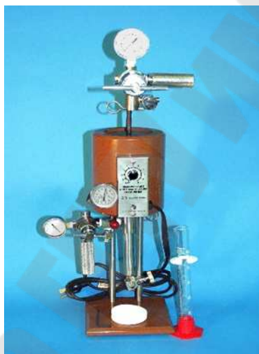
Рис. 2.3. Фильтр-пресс высокого давления и температуры фирмы «BAROID»
