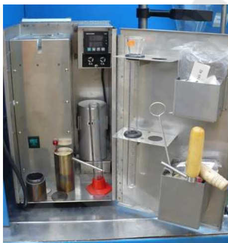
Рис. 4.3. Ретортный (муфельный) набор OFITE с цифровым регулятором температуры, 50 мл
