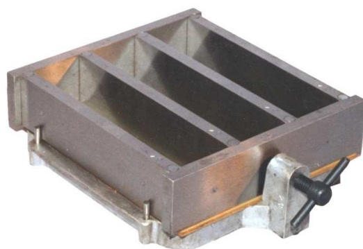
Рис. 8.3. Форма для изготовления цементных балочек размером 4 \times 4 \times 16 см
