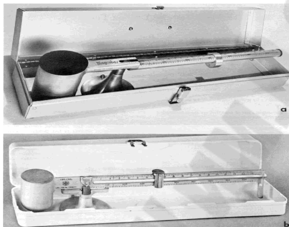
Рис. 1.2. Рычажные весы – плотномер ВРП-1
