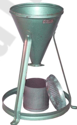
Рис. 5.2. Прибор для определения насыпной массы
