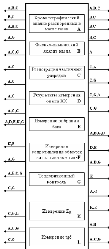
Рис. 1. Методы обнаружения дефектов, где A, B, C, D, E, F, G, K, L – условные обозначения дефектов
