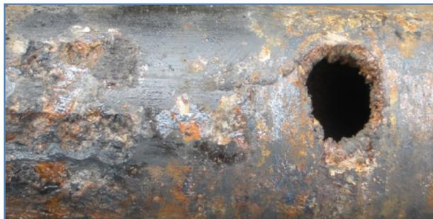
*Рис 1.* Состояние насосно-компрессионных труб 32Г1А N80 (Q) API Spec 5СТ при эксплуатации в условиях нагнетательной скважины Речицкого месторождения
