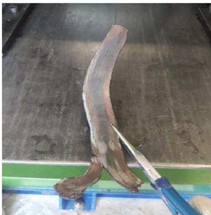
Рис. 2. Образец после асимметричной прокатки 2 : 10
