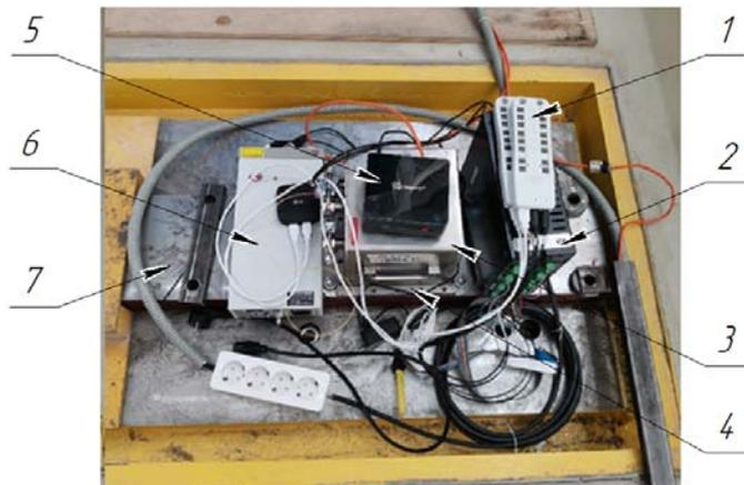
Рис. 3. Общий вид малогабаритного прецизионного лазерного инклинометра, установленного в павильоне детектора *MPD*:
