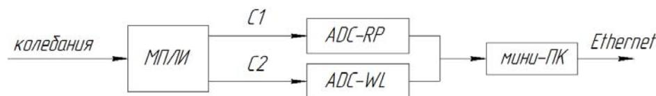
Рис. 1. Структурная схема основных элементов одного малогабаритного прецизионного лазерного инклинометра:
