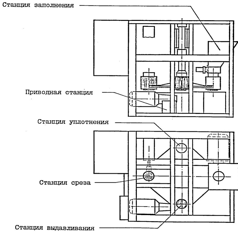
Рис. 1. Типовая компоновочная схема устройств для автоматического контроля свойств формовочных смесей
