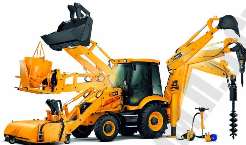
Рис. 22. Рабочее оборудование мобильной машины различного назначения
