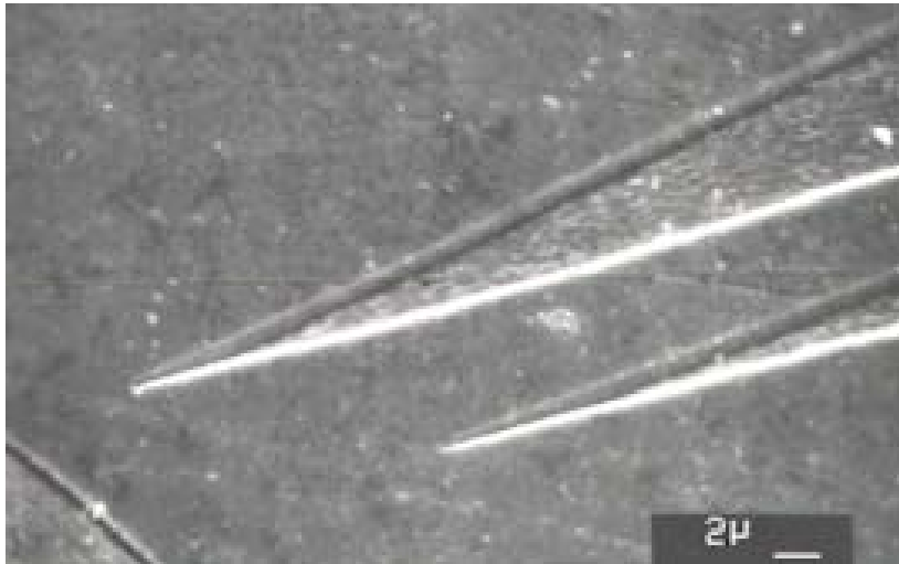
Рис. 2.22. Типичный вид клиновидных двойников формы треугольника (растровая электронная микроскопия с использованием NANOLAB-7)
