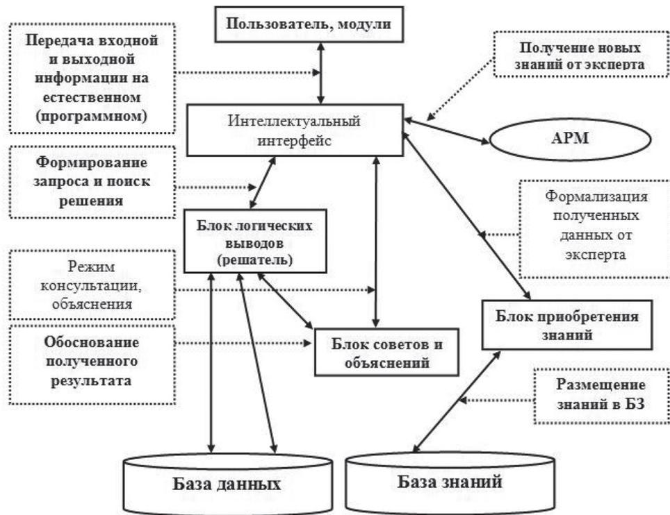
Рисунок 1. – Структурная схема интеллектуальной системы поддержки принятия решений
