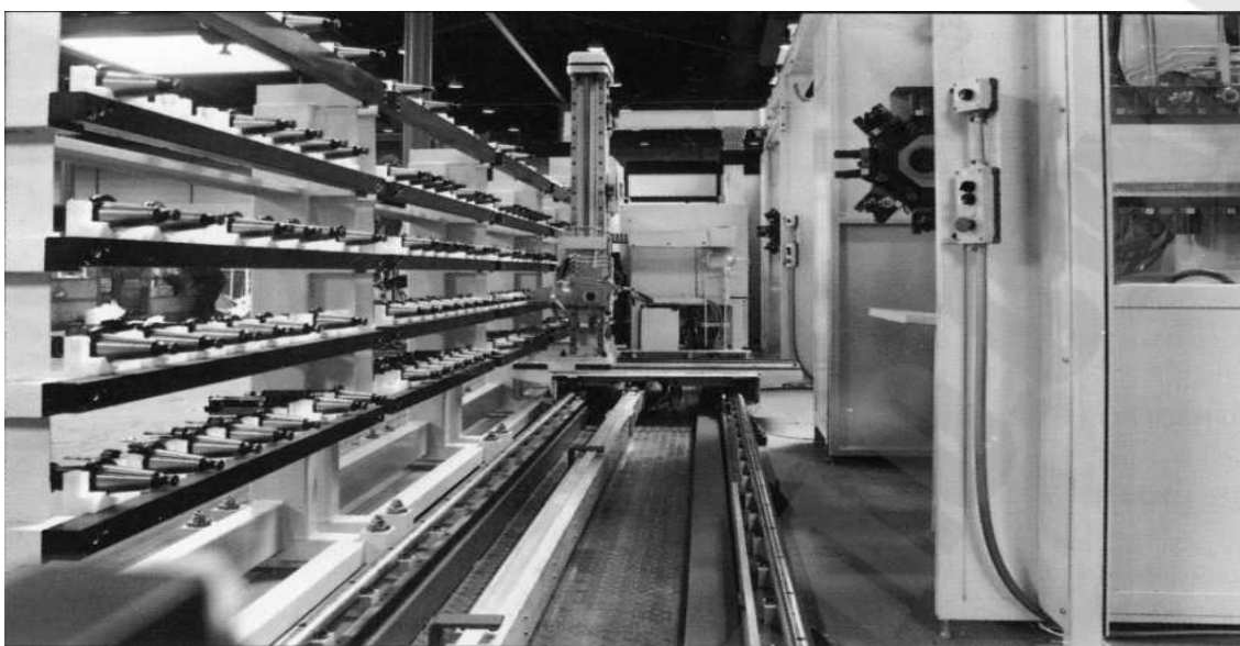
Рис.6.21.Робокар для замены инструментов непосредственно в магазине инструментов обрабатывающего центра
