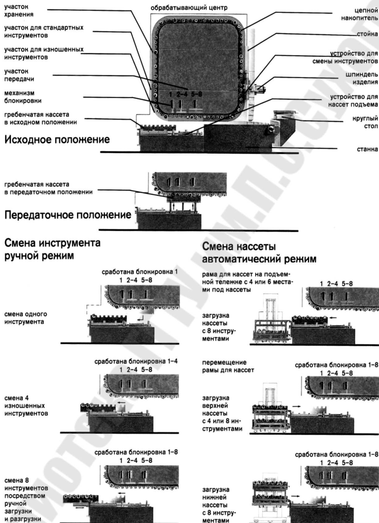
Рис.6.26. Последовательность операций при смене инструментов в ручном и автоматическом режимах при помощи устройства для скоростной смены инструмента (QTC)
