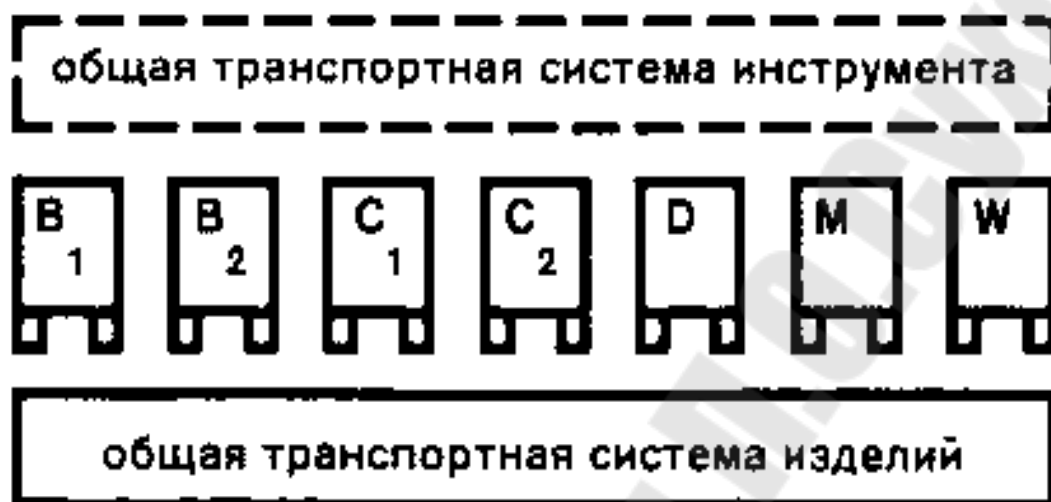
Рис.5.3. Структурная схема гибкого производственного острова.
