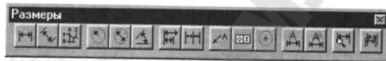
Рис. 17.21. Пиктограммное меню команд простановки размеров (кнопки соответствуют командам, слева направо: нанесения линейных, параллельных, ординатных размеров; радиусов; диаметров; базовых размеров; размерных цепей; выносок; предельных отклонений; маркировки центров окружностей; редактирования размеров; редактирования размерного текста; установки размерных стилей (длина стрелок, тип размерных линий, высота и расположения надписей размерного текста и пр.); обновления размера
