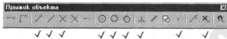
Рис.17.12. Инструментальная панель средств объектной привязки (так называемого «прыжка объекта») графического редактора AutoCAD
