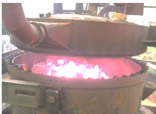
Рис. 1. Предварительный подогрев шихты в автономной установке
