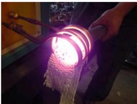
*Рис. 2. Индукционный нагреватель для высокочастотного нагрева заготовок*
