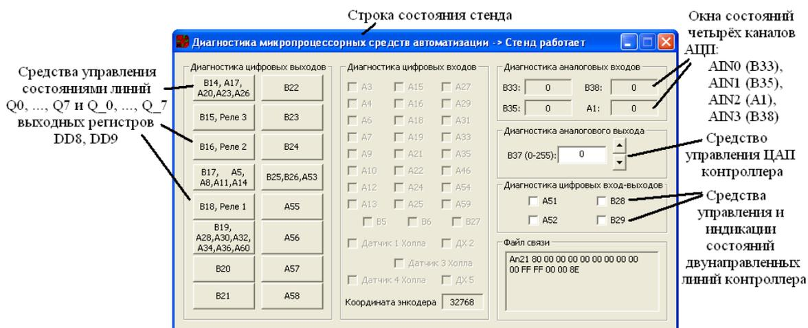
Рис. 2. Интерфейс пользователя программы диагностики монтажа микропроцессорных средств автоматизации
