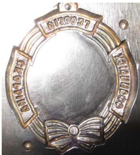
Рис. 1. Инструмент для объемной штамповки
