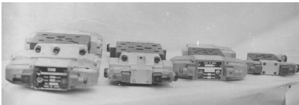
*Рис. 6.1.* Блоки распределителей типа БФР
