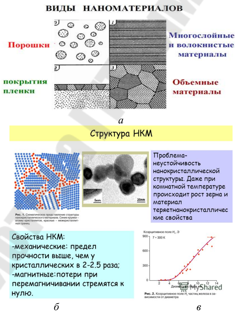
Рис. 1.11. Виды (а), структура (б) и сравнительные свойства (в) наноматериалов
