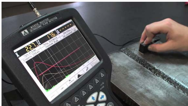
Рис. 4.8. Дефектоскопия сварных швов
