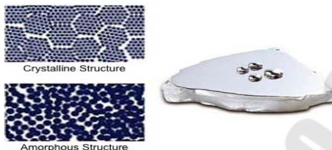
Рис. 1.2 Кристаллическая и аморфная структура сплавов
