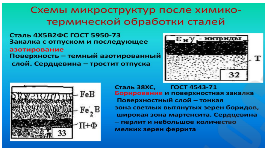
Рис. 1.16. Структурный градиент после обработки стали
