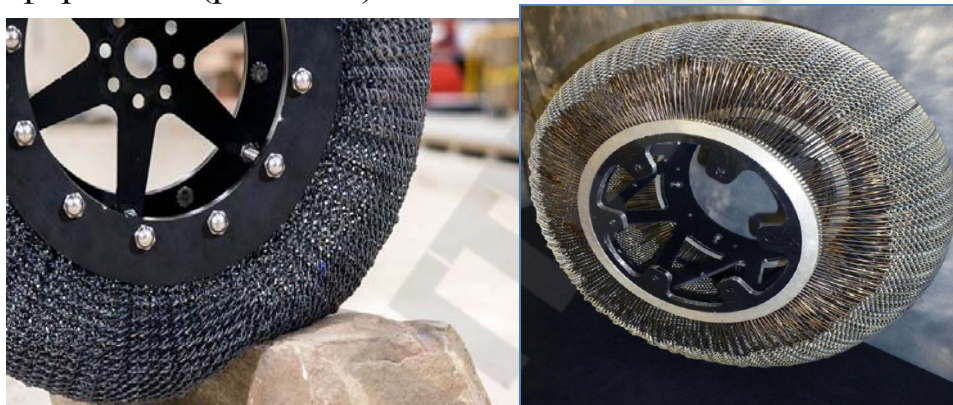
Рис. 1.25. Пример применения сплавов с памятью формы в автомобилестроении
