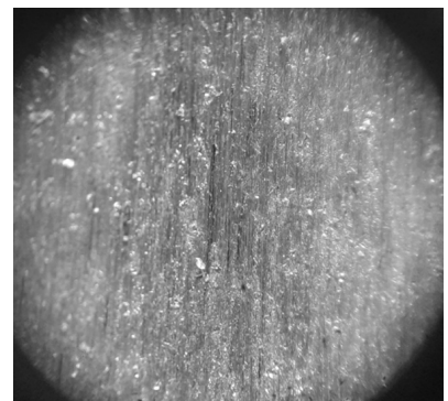
Рисунок 7 — Фотографии под микроскопом после испытаний: а — поверхности пластины с покрытием после испытаний; б — характер опорной пластины при 500 мкм; в — характер опорной пластины при 50 мкм
