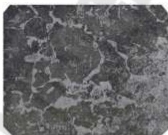
Рис. 1.6. Микроструктура стали содержащей 0,7 % С. Сетка феррита и перлит. x250
