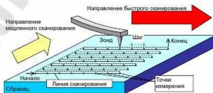
Рис. 6.6. Движение образца под зондом в процессе сбора данных
