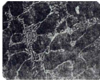
Рис. 1.7. Микроструктура сплава свинец – 10 % сурьмы. x100
