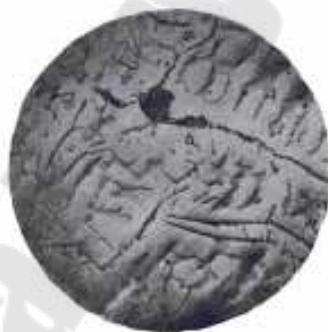
Рис. 1.3. Рельеф на нетравленном микрошлифе
