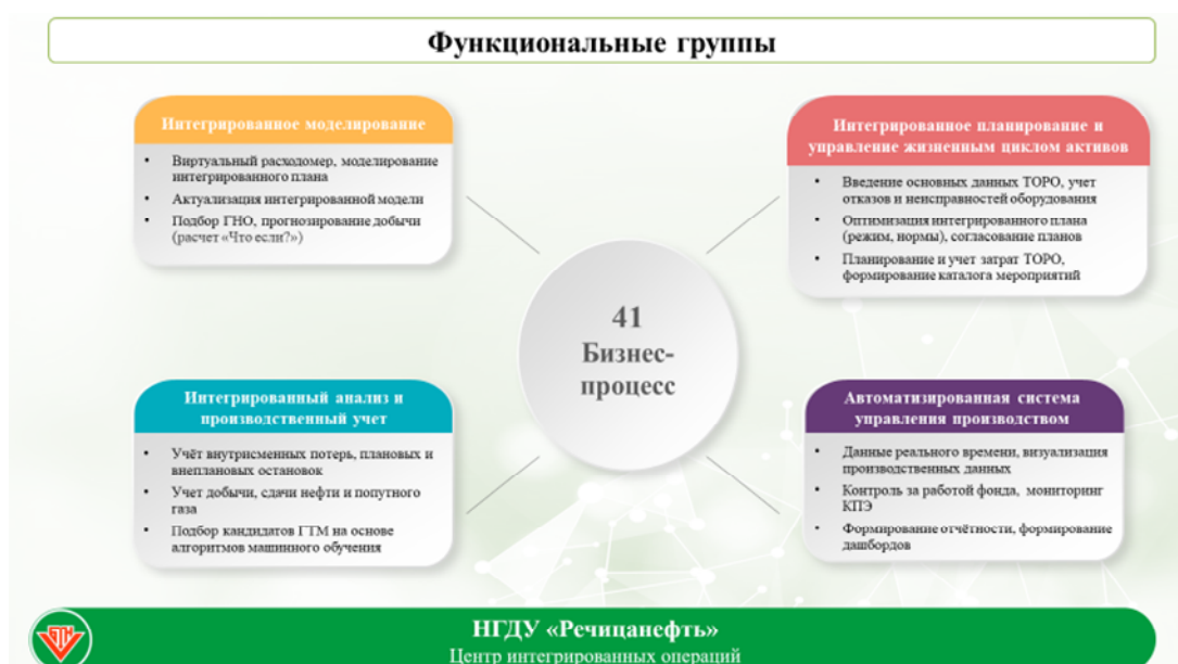
Рис. 2. Функциональные группы программного обеспечения «Цифровое месторождение»
