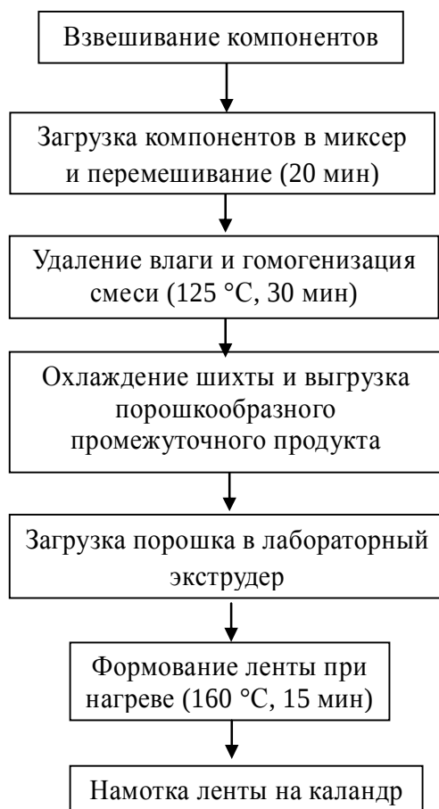
Рис. 3. Схема получения ленты на основе ПКЛ и порошка соломы экструзионным методом
