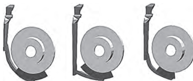
Рис. 3. Примеры литниковых систем с минимизацией турбулентности
