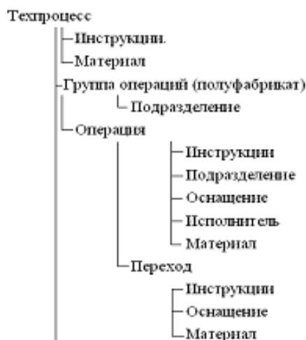
Рис. 22 Иерархия данных техпроцесса T-FLEX Технология
