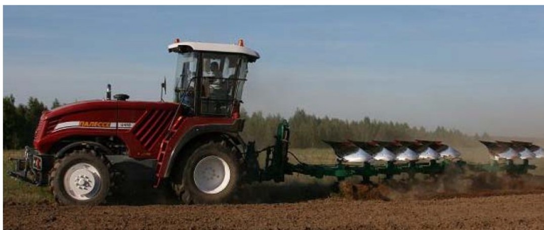
Рис. 1. Пахотный агрегат на базе универсального энергетического средства УЭС-290/450
