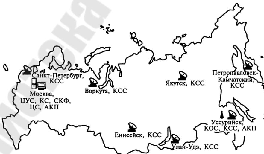
Рисунок 10.4 – Размещение станций контроля и управления системы ГЛОНАСС: ЦУС – центр управления системой ГЛОНАСС; ЦС – центральный синхронизатор; КС – контрольная станция; СКФ – система контроля фаз; КОС –
