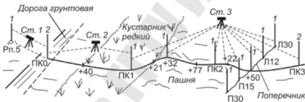
Рисунок 17.3 – Схема нивелирования по пикетам
