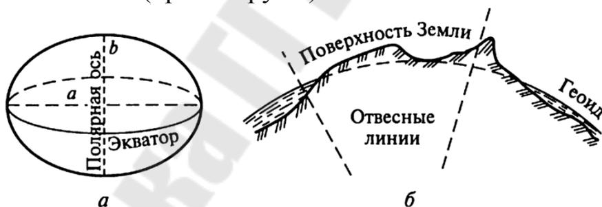
Рисунок 2.1 – Формы земной поверхности: а – земной эллипсоид; б – геоид
