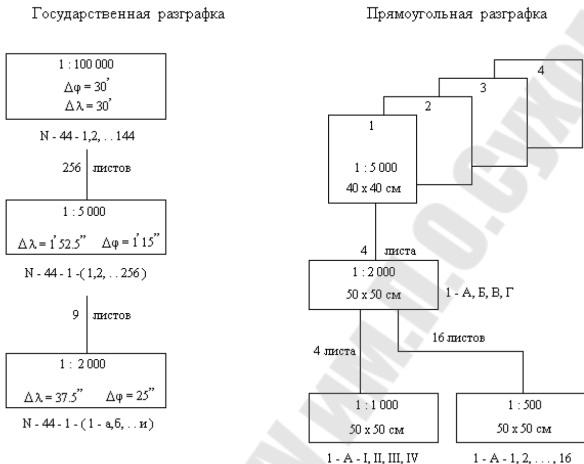
Рисунок 3.5 – Схема государственной и прямоугольной разграфки
