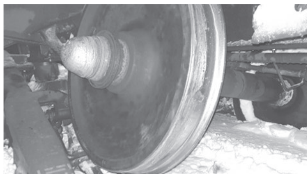
Рисунок 1 — Излом шейки оси колесной пары вагона
