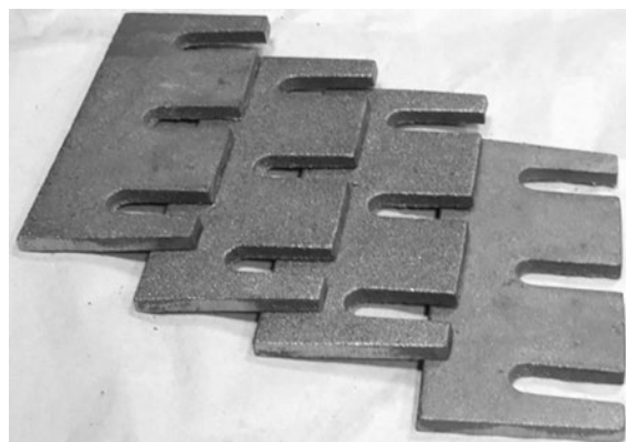
Рисунок 1 — Фото режущего барабана комбайна КВК-800 с установленными ножами (а) и ножей из высокопрочного чугуна (б)
