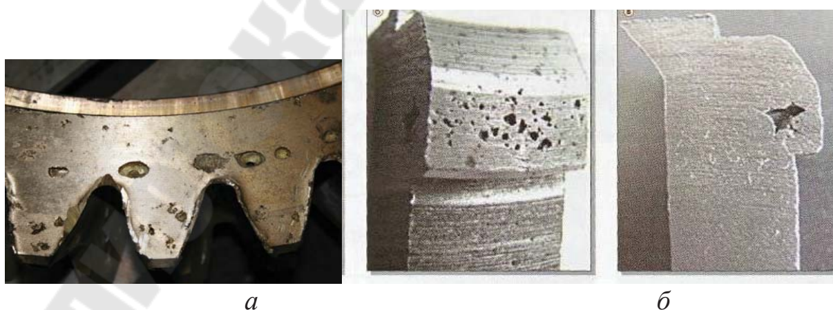
Рис. 1. Дефекты отливок: а- газовые раковины; б- подкорковая раковина
