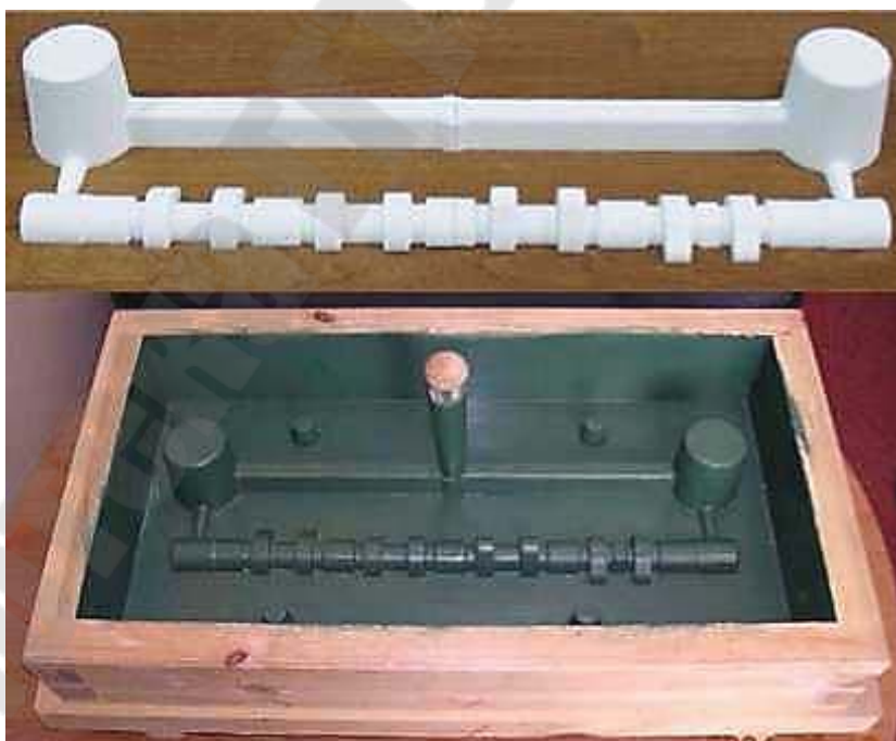
Рисунок 133 – Технологическая оснастка для формовки распределительного вала ДВС
