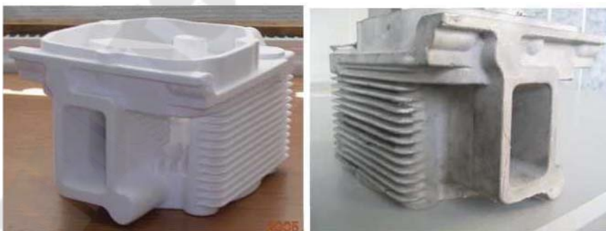
Рисунок 130 – Полистирольная модель и отливка головки цилиндра ДВС
