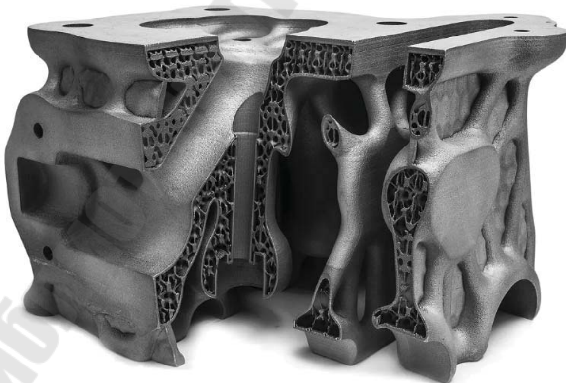
Рисунок 202 – Распечатанная деталь из металла в разрезе
