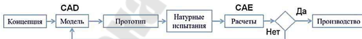
Рисунок 107 – Традиционный подход к проектированию конструкций
