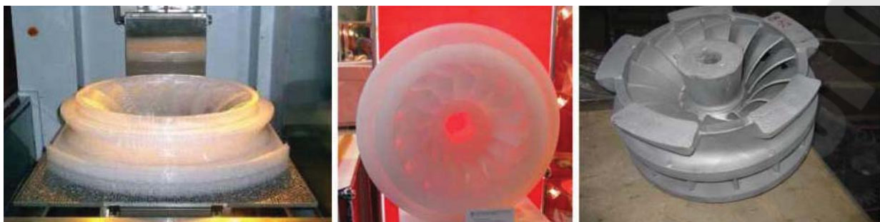
Рисунок 137 – SLA-модель и отливка рабочего колеса турбоагрегата
