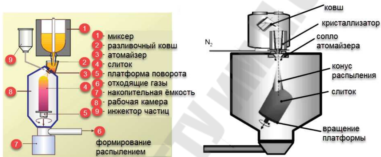
Рисунок 22 – Схема технологии Spray forming : 1 – тигель; 2 – сливное устройство; 3 – подвод газа; 4 – выращиваемая болванка; 5 – вращающаяся подложка; 6 – отвод газа; 7 – бункер для порошка; 8 – камера распыления; 9 – (опция) бункер для подшихтовки дополнительного материала
