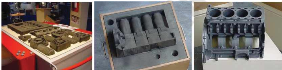
Рисунок 151 – Выращенные фрагменты формы (ProMetal), форма в сборе и отливка блока (чугун)
