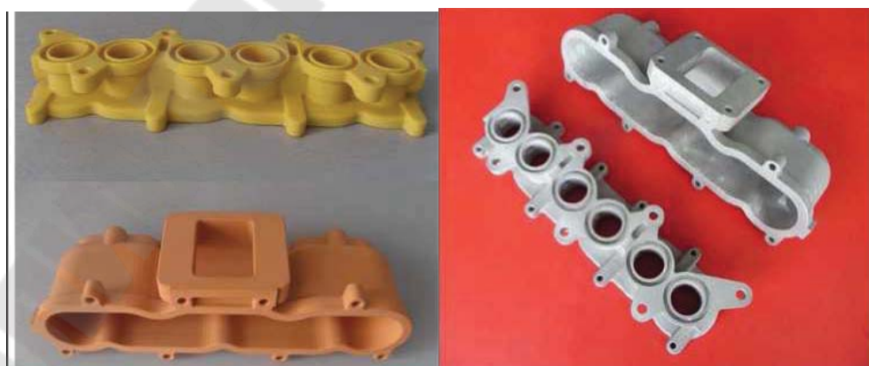
Рисунок 139 – Модели Envisiontec и отливки деталей ДВС, алюминий
