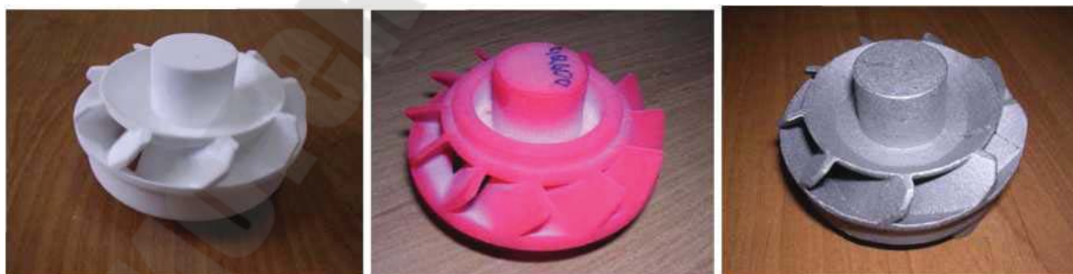
Рисунок 131 – Полистирольная модель (после выращивания и инфильтрации) и отливка, чугун
