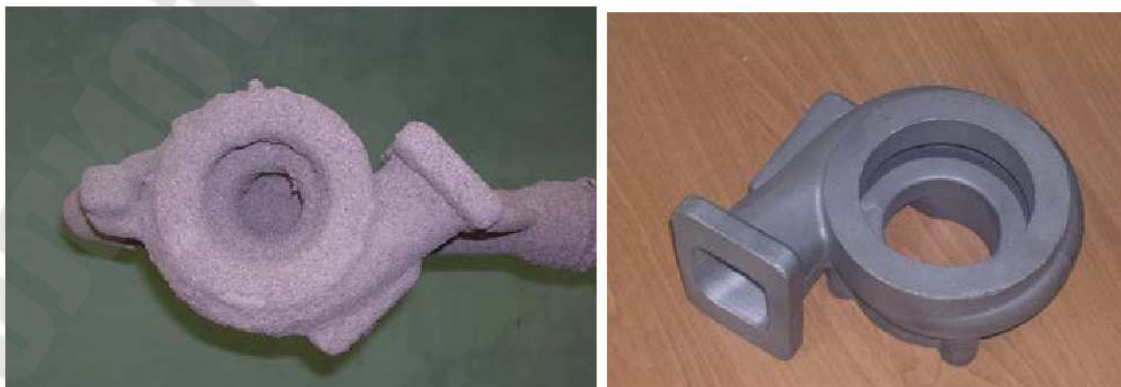
Рисунок 142 – Оболочковая форма и отливка корпуса турбины (чугун), полученные по восковой синтез-модели
