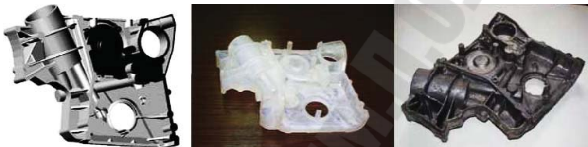
Рисунок 136 – CAD-модель, SLA-модель и отливка передней крышки ДВС «в землю»
