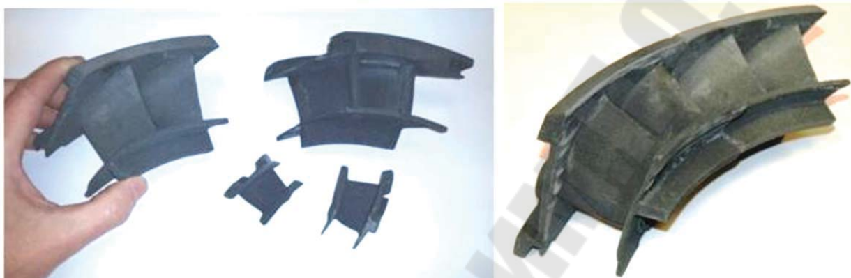
Рисунок 63 – Детали газотурбинного двигателя из SiC с упрочняющими волокнами SiC, полученные с помощью технологии Binder Jetting (сегменты турбинных лопаток)
