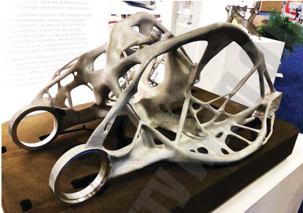
Рисунок 190 – Распечатанная «в металле» деталь после механической обработки рабочих поверхностей
