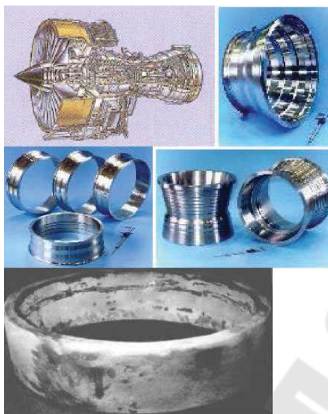
Рисунок 163 – Примеры деталей авиадвигателя, полученные с использованием технологии «Spray forming»
