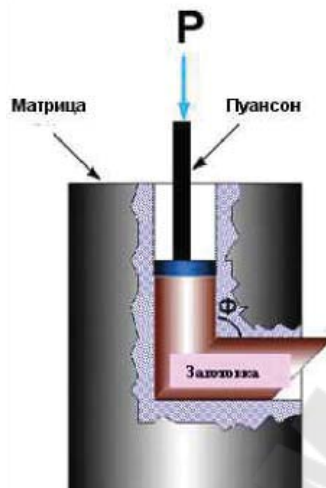
Рисунок 165 – Схема процесса РКУП
