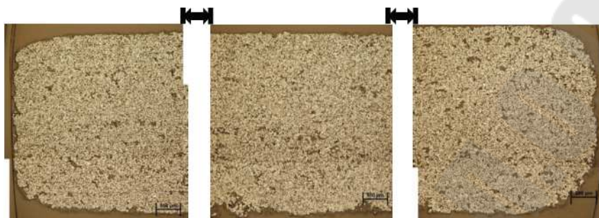
Рисунок 56 – Оптические изображения шлифов образцов из SiC, полученных по технологии Binder Jetting из порошка зернистостью F240, после пропитки поликарбосиланом
