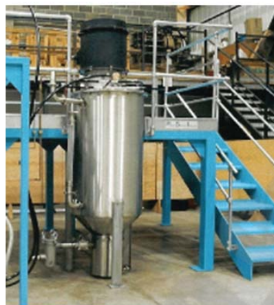
Рисунок 11 – Распыление расплава газом: a – схема установки компании PSI; б – установка компании «РСТ» УР-5
