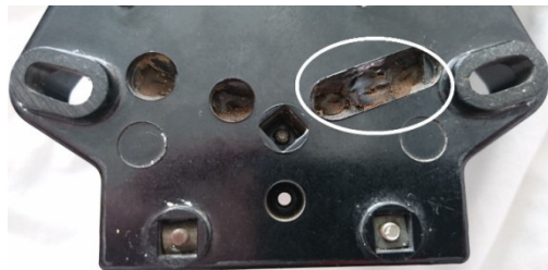
Рисунок 4 – Хищение электроэнергии с помощью изменения месторасположения шунта
