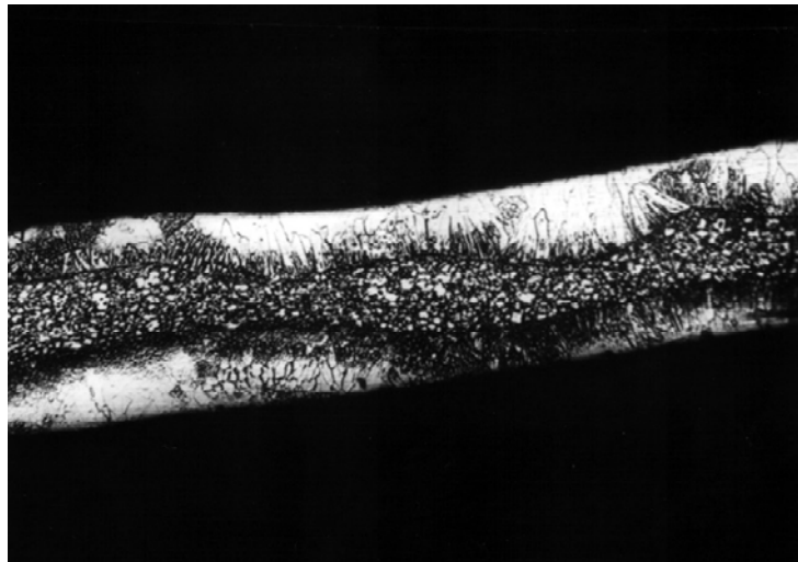
Рис. 4.17. Микроструктура поперечного сечения ленты по толщине с периодическим изменением высоты столбчатых кристаллов ( \lambda – длина волны между наибольшими высотами столбчатых кристаллов)
