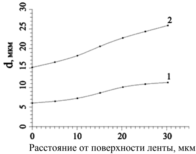
Рис. 4.20. Изменение среднестатистического размера ширины столбчатых кристаллов (параметр d ) по толщине ленты длиной 1 м (1) и длиной 21 м (2) от начала процесса
