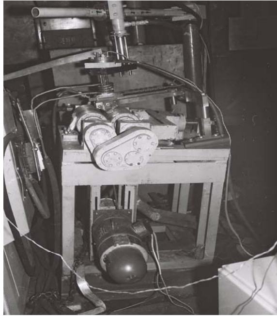
Рис. 6.7. Общий вид экспериментальной установки для двухвалковой быстрой закалки расплава
