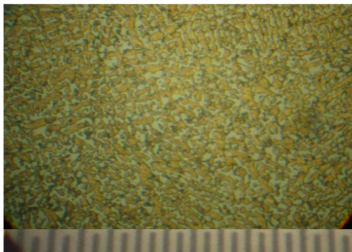
Рис. 6.23. Микроструктура быстрозакаленного сплава \text{Cu}_{58}\text{Ni}_4\text{P}_7\text{Fe}_{0,2}\text{Pb}_2\text{Zn}_{28,8} (мас. %), травление, \times 1000 ; цена деления шкалы – 0,005 мм
