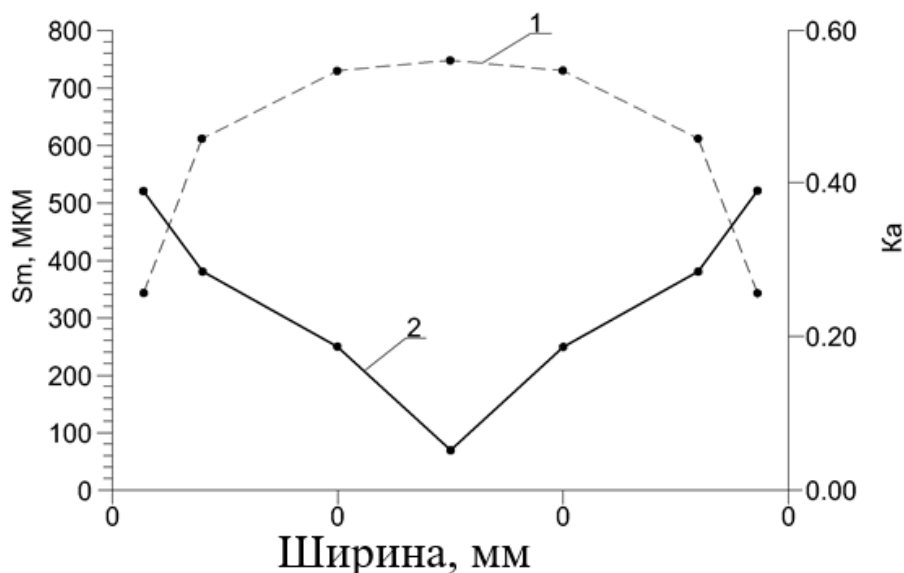
Рис. 4.9. Распределение по ширине ленты среднего шага микровыступов S_m (1) и коэффициента анизотропии угла наклона боковых сторон микрограней K_a (2), полученных в жестких бандажах
