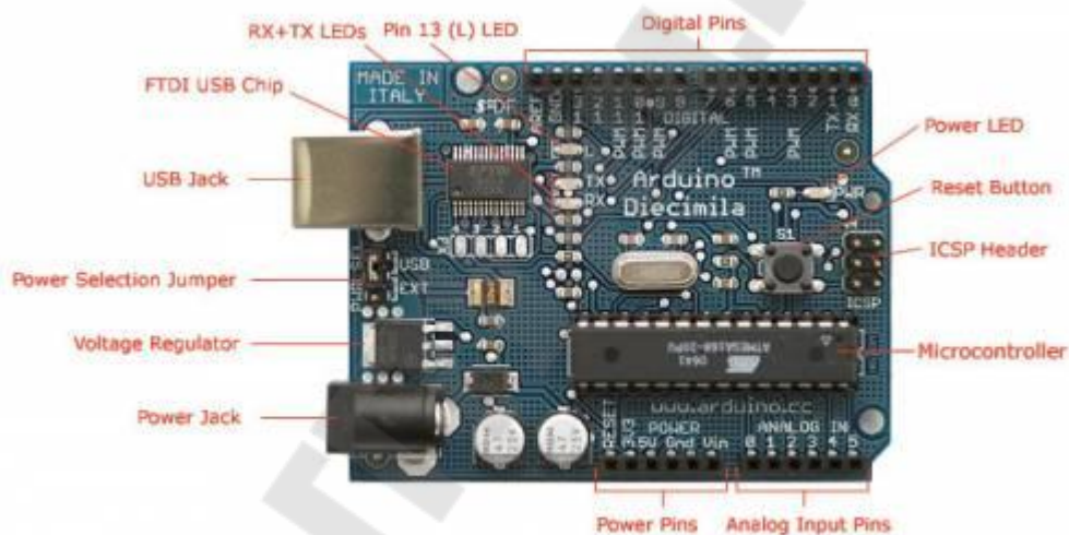
Рисунок 3.1 – Компоненты платы Arduino
