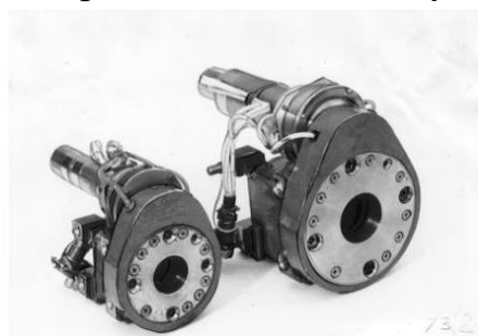
Рисунок 7.2 – Электромеханические вращательные модули-приводы типа ПРЭМ.
