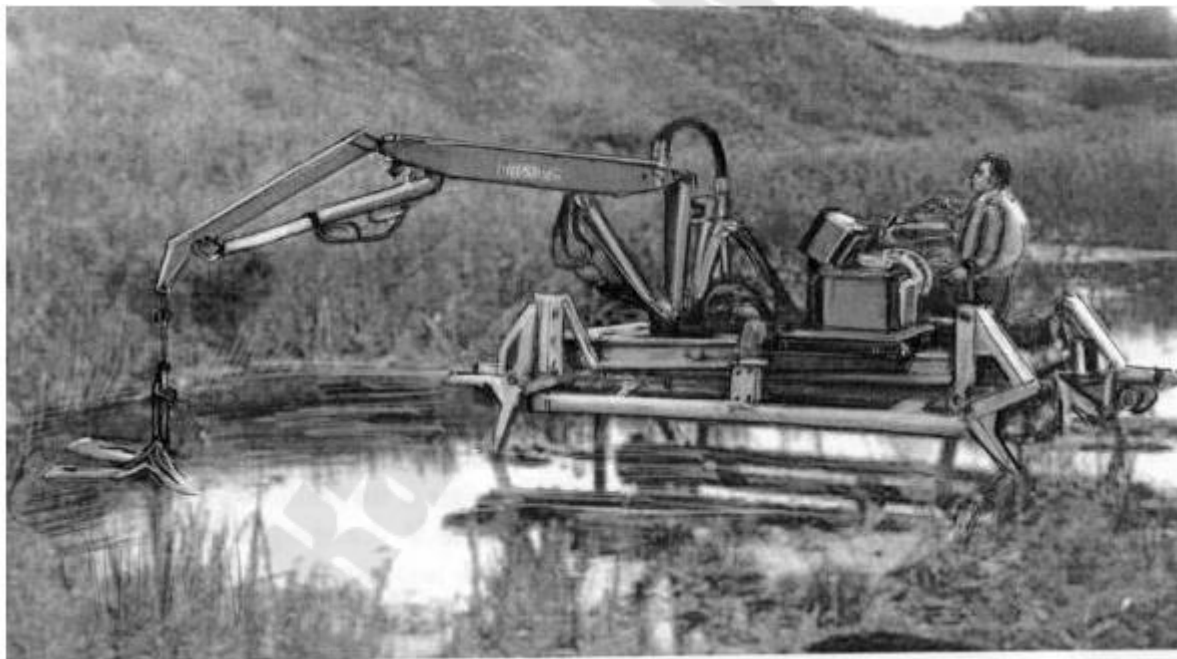
Рисунок 11.4 – Мобильный четырехногий шагающий робот для сбора разлитых нефтепродуктов. (Волгоградский ГТУ)
