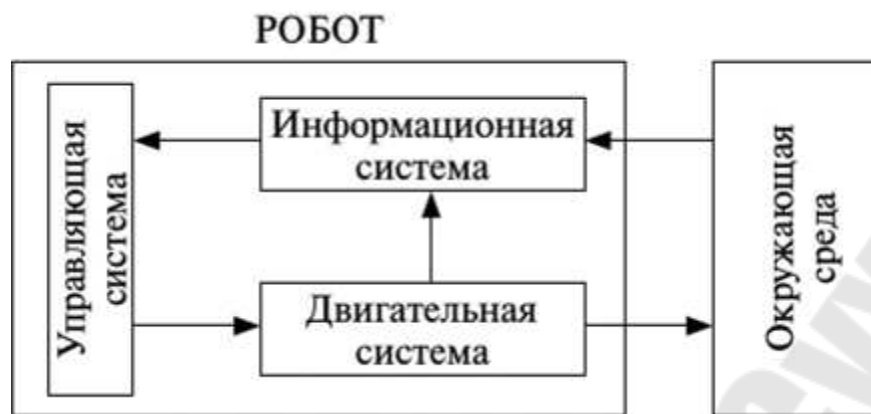
Рисунок 2.1 – Функциональная схема робота
