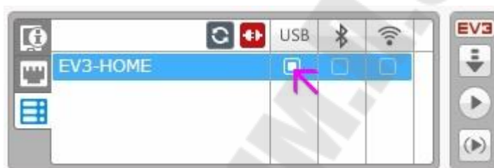
Рисунок 7 – Индикатор подключения блока EV3
