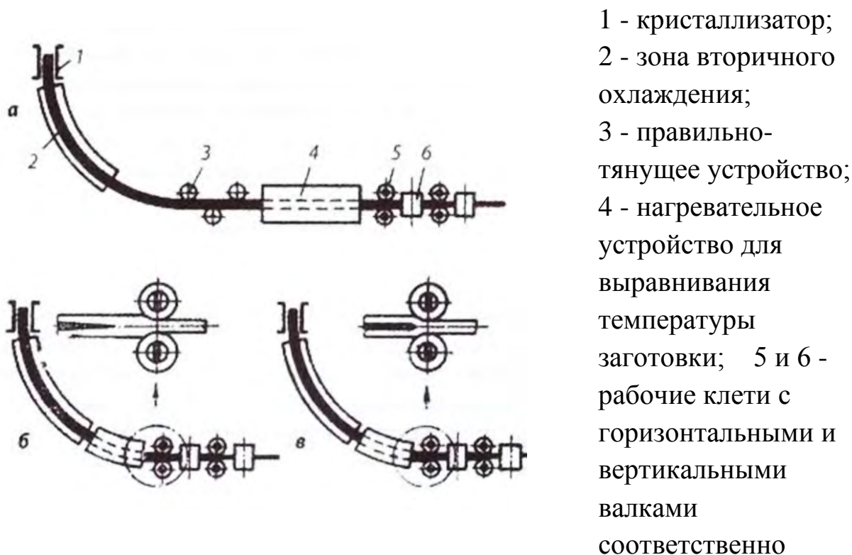
Рисунок 9.6 – Схемы заготовочных литейно-прокатных агрегатов, реализующих способ B-S-R.
