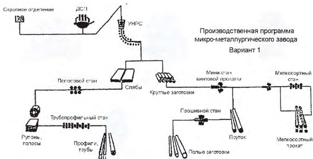
Рисунок 5.20 – Схема производства металлопродукции на микро-заводе
