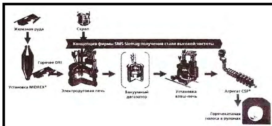
Рисунок 5.16 – Технологическая схема мини-завода с полным циклом, работающего на комбинированном сырье
