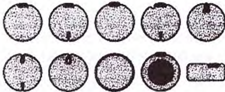
Рисунок 7.4. – Поперечные сечения порошковой проволоки
