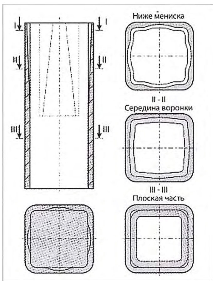
Рисунок 8.6 – Гильза кристаллизатора конструкции VMS и схема затвердевания корочки слитка
