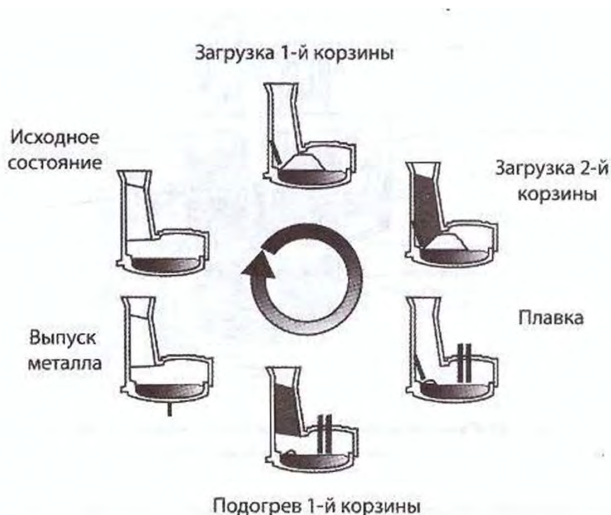
Рисунок 6.13 – Схема загрузки и работы шахтной печи
