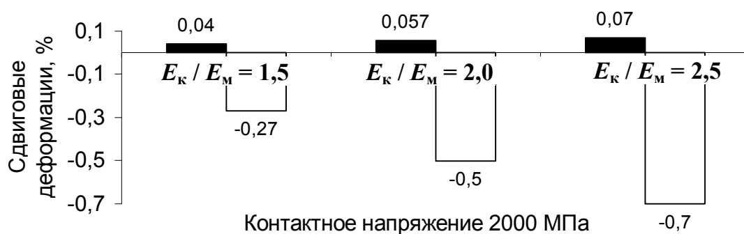
Рис. 5.8. Сдвиговые деформации, возникающие в зоне тонкой прослойки материала матрицы между включениями:
