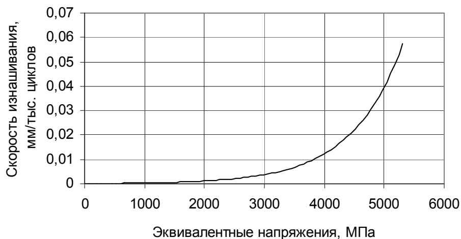
Рис. 7.6. Зависимость скорости изнашивания рабочей поверхности матриц от величины эквивалентных напряжений
