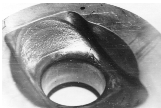
Рис. 7.10. Характер повреждений гравюры матрицы, рабочая полость которой изготовлена с радиусом сопряжения формообразующих поверхностей 5 мм
