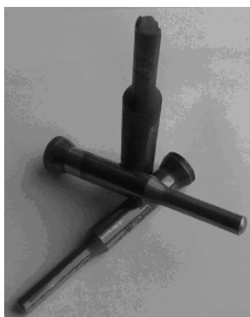
Рис. 8.10. Пуансон обратного выдавливания ниппеля шлангового держателя
