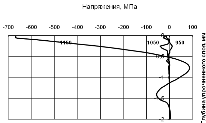
Рис. 4.8. Распределение остаточных напряжений в поверхностном слое после науглероживания и последующей термообработки (цифрами у кривых обозначена температура нагрева под закалку)
