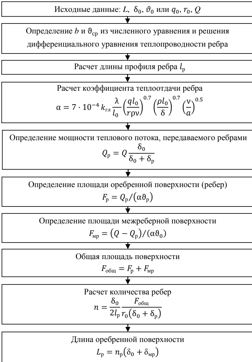
Рисунок 10. – Блок-схема теплового конструктивного расчета оребренной поверхности
