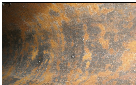
Рис. 2. Состояние насосно-компрессионных труб 32ХГ Р110 API Spec 5СТ API Spec 5СТ при эксплуатации в условиях нагнетательной скважины Речицкого месторождения
