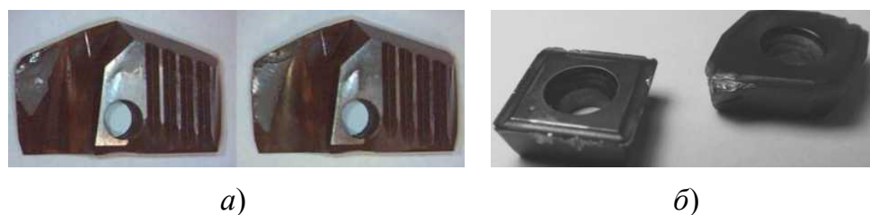
Рис. 1.2. Разрушение сменных режущих элементов сборных сверл: а – головок; б – пластин
