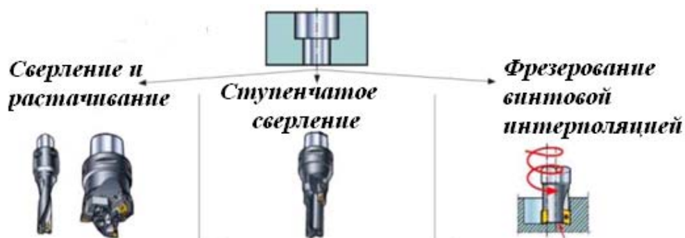
Рис. 1.8. Различные способы получения отверстий по рекомендациям фирмы «Sandvik Coromant»
