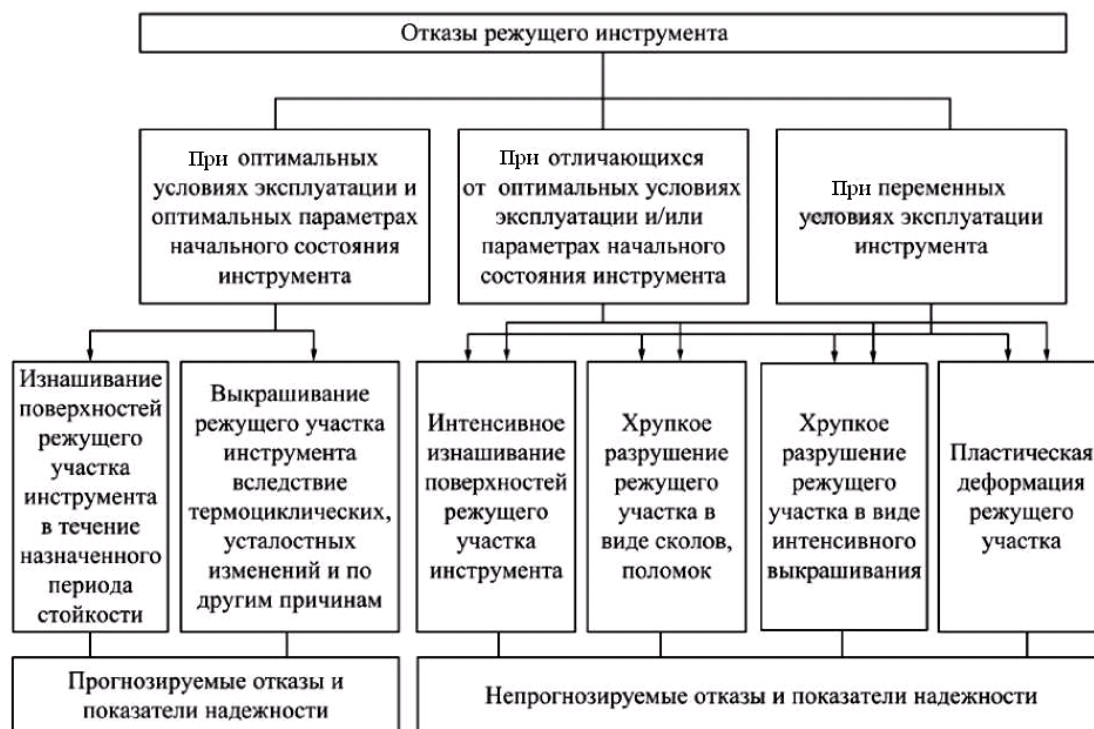
Рис. 1.5. Классификация отказов режущей части инструмента [14]
