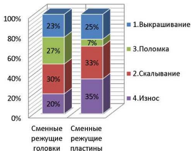
Рис. 1.3. Доли отказов сменных режущих элементов сборных сверл
