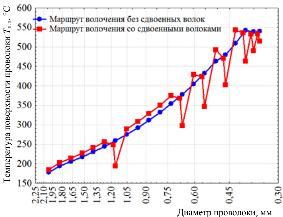
Рис. 5.13. Изменение температуры поверхности проволоки T_{п.п} в маршруте волочения проволочной заготовки диаметром 2,145 мм из стали 96
