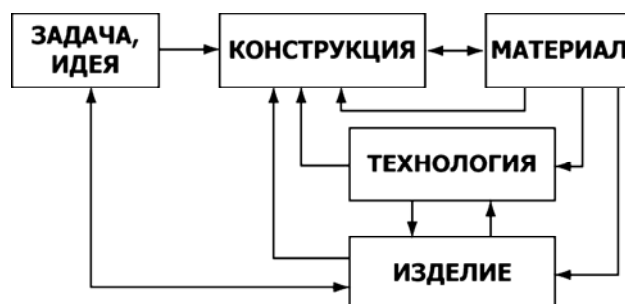
Рис. 1. Место и роль материала в процессе создания новой техники (адаптивная схема)
